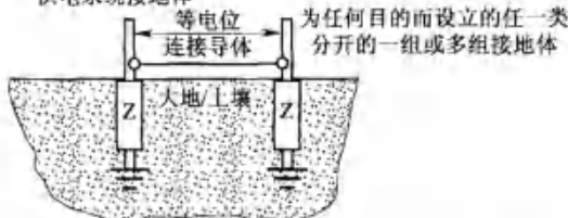
图 7 IEC 和美国 NEC 要求在各组接地体之间做等电位连接
