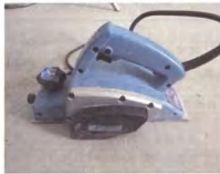
电刨子示例图 (用于刨平板材)
