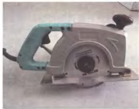
切割锯示例图 (用于切锯板材和砌块)
