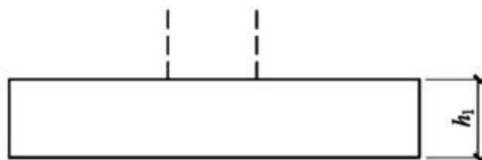
图2.3.2-2 单阶普通独立基础竖向尺寸
