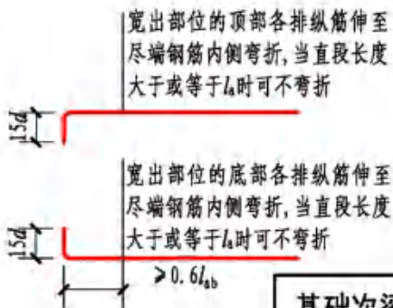
支座两边梁宽不同钢筋构造
