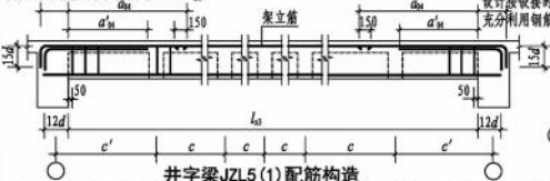
井字梁 JZL5 (1) 配筋构造
