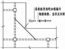
图7.2.9 悬挑板阴角附加筋Cis引注图示
