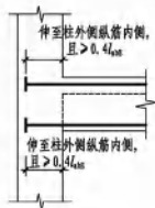
端支座加锚头(锚板)锚固
